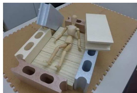
(6) 要救助者人形は規定された姿勢でベッドの上に設置されており、ベッドを囲むようにガレキが配置されている。
