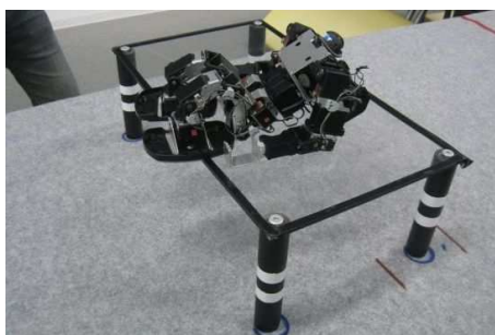
(4) トンネルくぐりと段差乗り越えは同じ支柱を使う。段の高さは、板厚 5mm を加え、185mm である。
