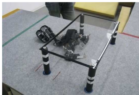
(2) トンネルくぐり。写真の支柱の高さは 183mm。
