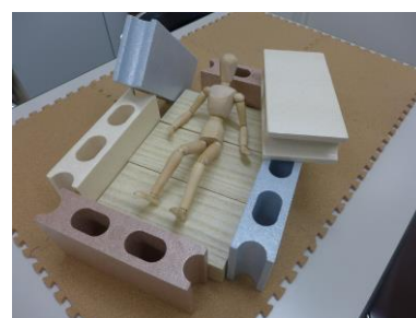
(6) 要救助者人形は規定された姿勢でベッドの上に設置されており、ベッドを囲むようにガレキが配置されている。
