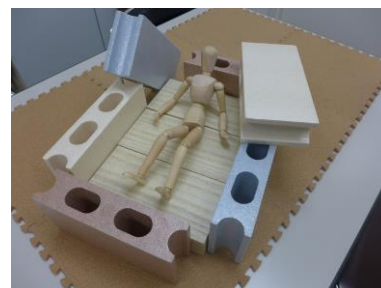
(6) 要救助者人形は規定された姿勢でベッドの上に設置されており、ベッドを囲むようにガレキが配置されている。
