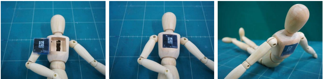
図： 要救助者人形に埋め込まれた加速度センサ無線タグ（前の機種 TWELITE 2525A）
